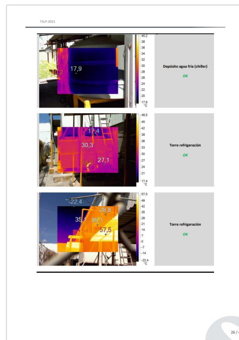
Ilustración 5: Ejemplo de informe de Auditoría Energética y actuaciones de eficiencia energética propuestas para una planta del Grupo (Teknia Manresa)
